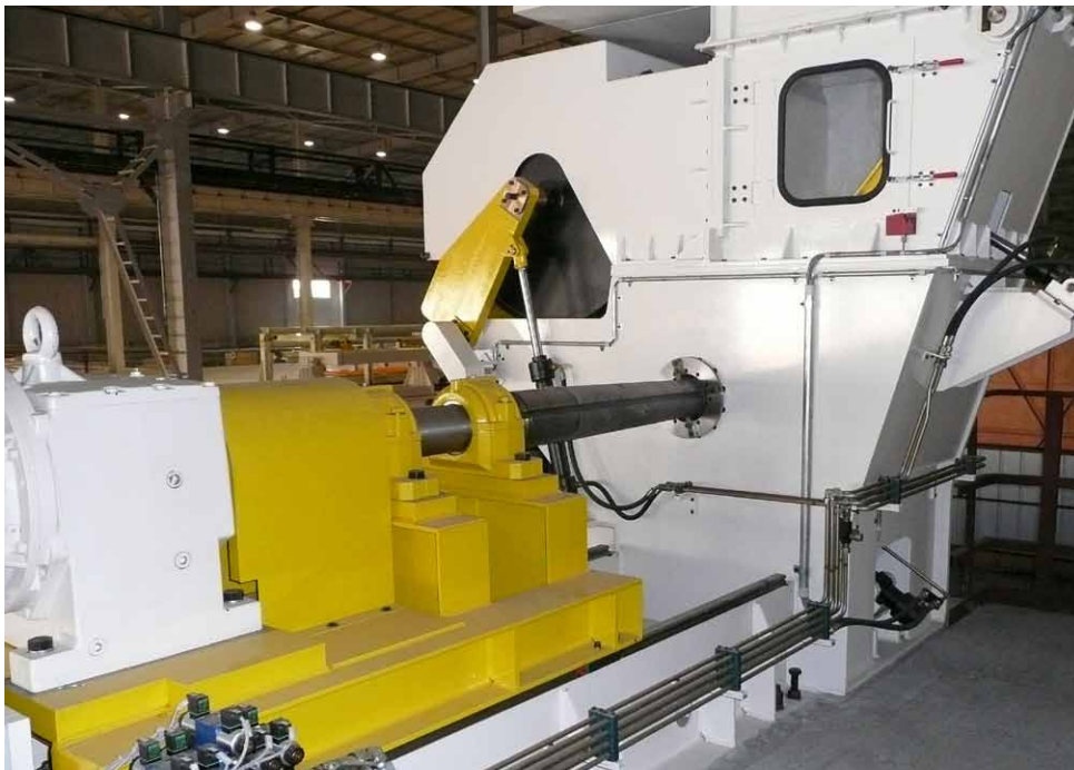
Scrap baller in underfloor design for automatic winding of the scrap leading edge / Saumstreifenwickler in Unterflurausführung mit automatischem Anwickeln des Saumanfangs
