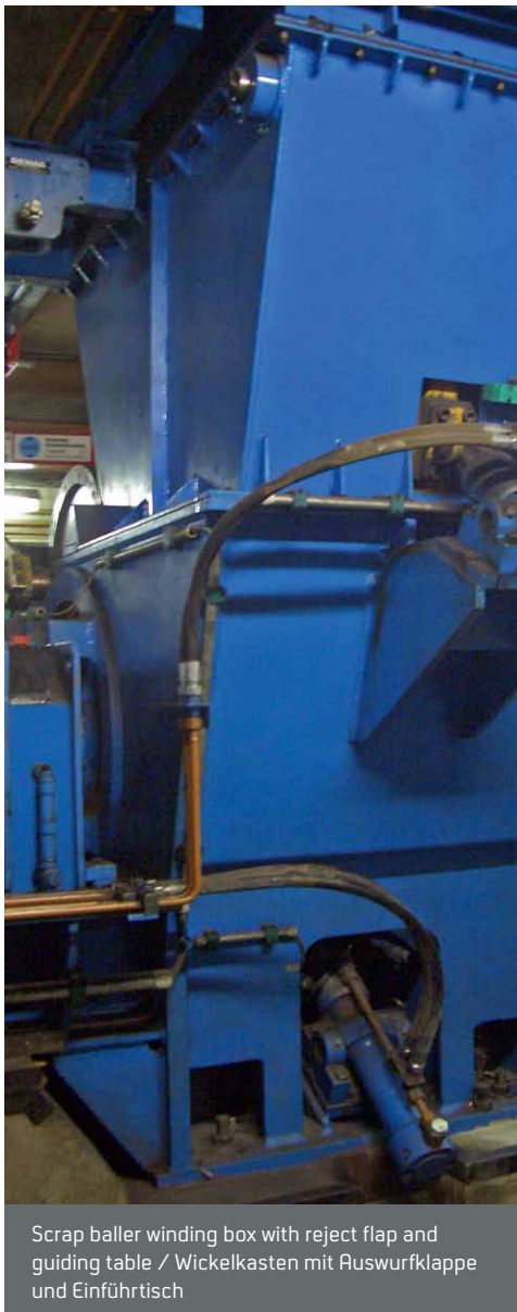
Scrap baller in underfloor design for automatic winding of the scrap leading edge / Saumstreifenwickler in Unterflurausführung mit automatischem Anwickeln des Saumanfangs
