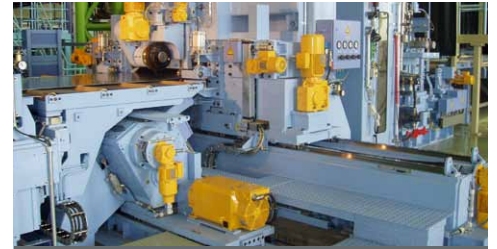
Scrap chopper in a GEORG inspection line for hot dip galvanized coils / Saumstreifenschneider in einer GEORG Inspektionslinie für feuerverzinkte Coils
