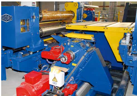
Scrap chopper in a slitting line / Saumstreifenschneider in einer Längsteilanlage
