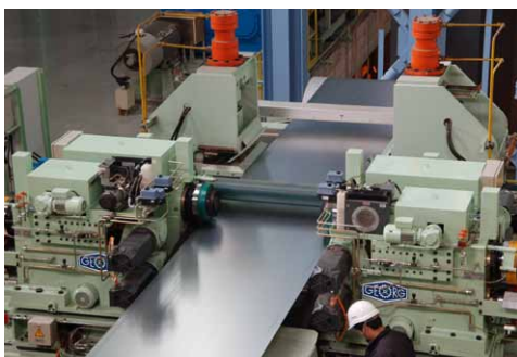
GEORG double head edge-trimming shears with rotating turret type cutting heads in a strip processing line / GEORG Wendekopfbesäumschere mit drehbaren Schneidköpfen in einer Prozesslinie
