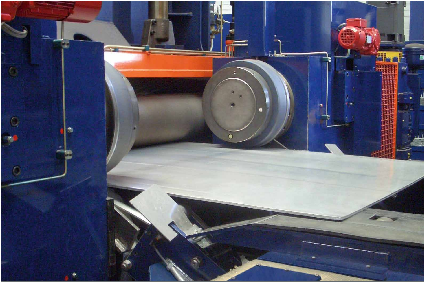
Edge-trimming shear for heavy gauge aluminium up to 15 mm / Besäumschere für dickes Aluminiumband bis zu 15 mm
