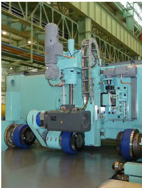
Edge-trimming shear for heavy gauge aluminium up to 15 mm / Besäumschere für dickes Aluminiumband bis zu 15 mm
