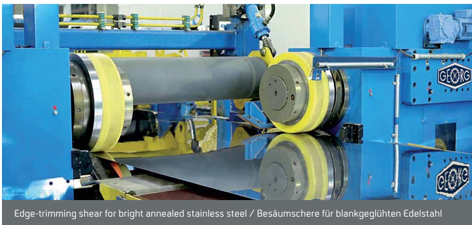
Edge-trimming shear with centre slit and scrap chopper in a GEORG inspection line for hot dip galvanized coils / Besäumschere mit Mittenschnitt und Saumschrottschneider in einer GEORG Inspektionslinie für feuerverzinkte Coils
