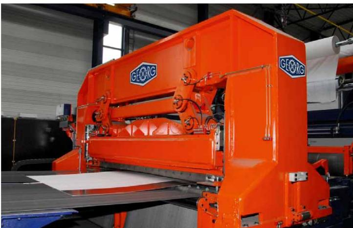
Flying shear designed as a continuous cut-to-length shear for a wide thickness and width range of aluminium / „Fliegende“ Schere als kontinuierlich schneidende Querteilschere für dicke und breite Aluminiumbänder
