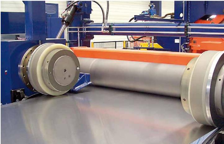
Edge-trimming shear for aluminium strip widths of 1,000 – 2,800 mm and a thickness range of 1 – 8 mm / Besäumschere für Aluminiumbänder mit Bandbreite 1.000 – 2.800 mm und Banddicken von 1 – 8 mm
