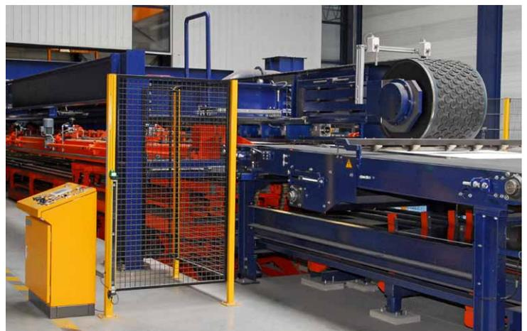
Combined vacuum stacker with support bars for stacking of precut aluminium sheets / Kombierter Vakuumbandstapler mit Stützleisten zum Abtafeln der geschnittenen Aluminiumtafeln
