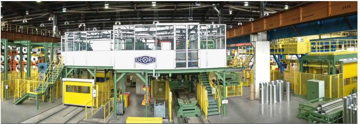
Edge-trimming lines at top speed / Besäumlinien für Höchstgeschwindigkeit
