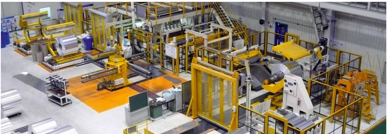
Slitting lines for aluminium / Längsteillinien für Aluminium
