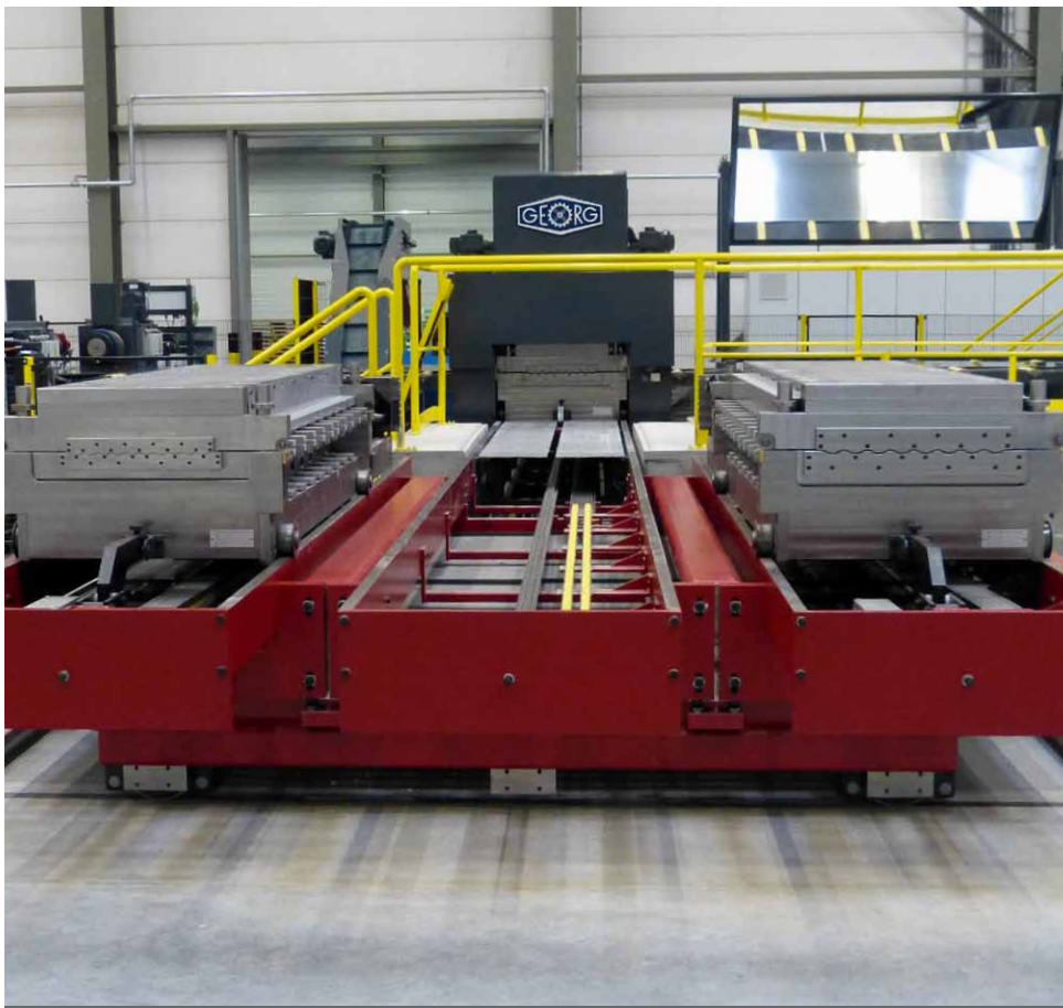
Cassette change car for 3 cassettes WK 70, WK 55 und WK 45 x 2,000 mm / Richtkassetten Wechselwagen 3-fach für WK 70, WK 55 und WK 45 x 2.000 mm
