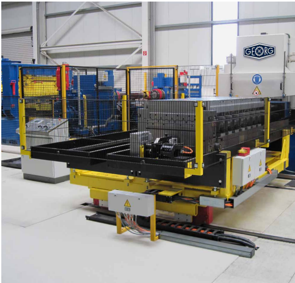
Cassette change car for 2 cassettes WK 65 and WK 40 x 1,600 mm / Richtkassetten Wechselwagen 2-fach für WK 65 und WK 40 x 1.600 mm
